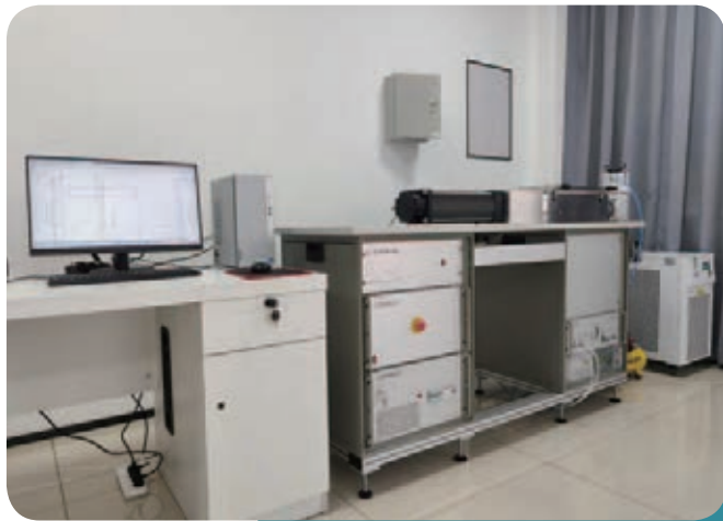
新增熱膨脹變形／相變測試儀
